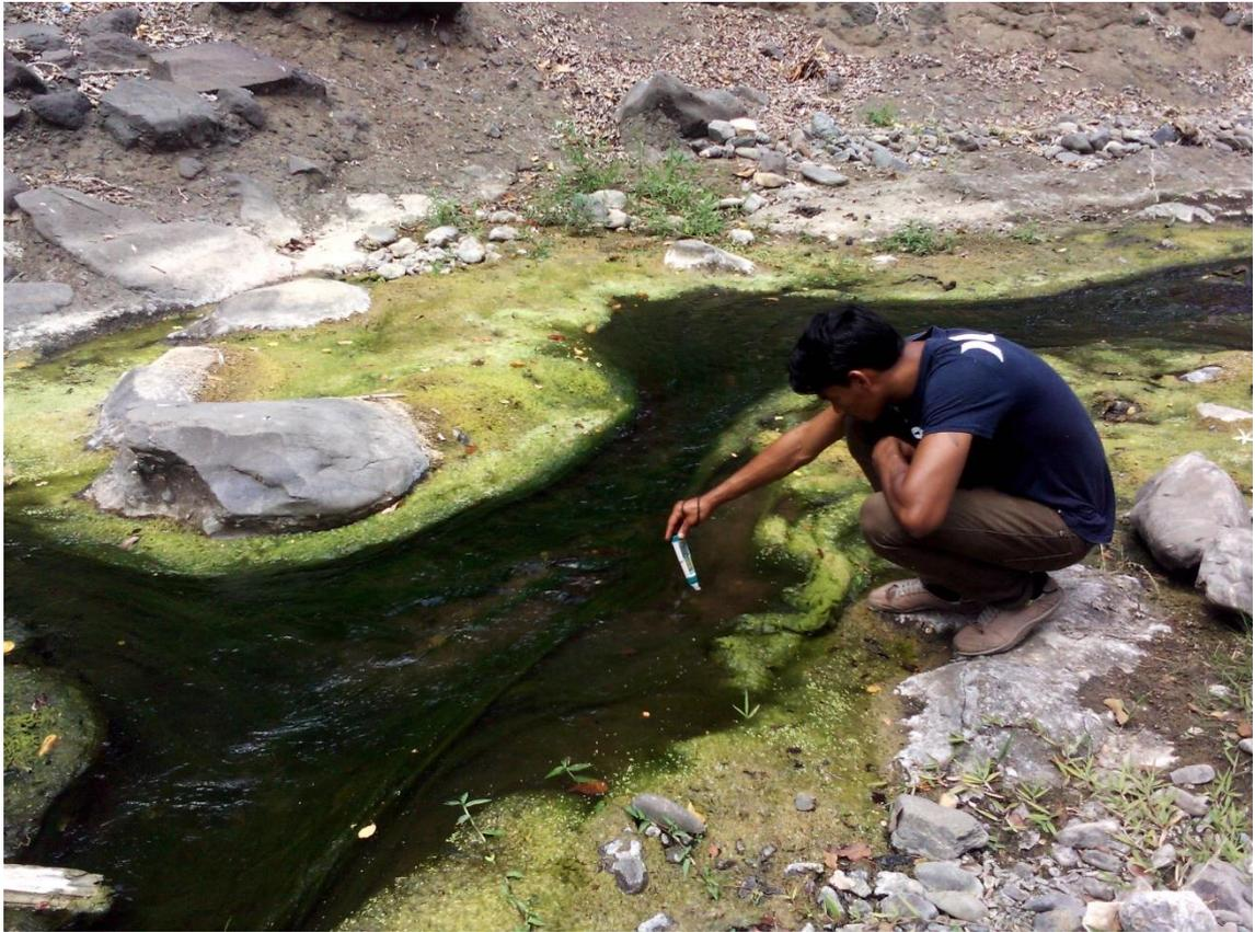
Figura 11.- Medición de Parámetros físico-químicos en la toma de agua para el proyecto piscícola en Alauca, el Paraíso (Abril 2014).
