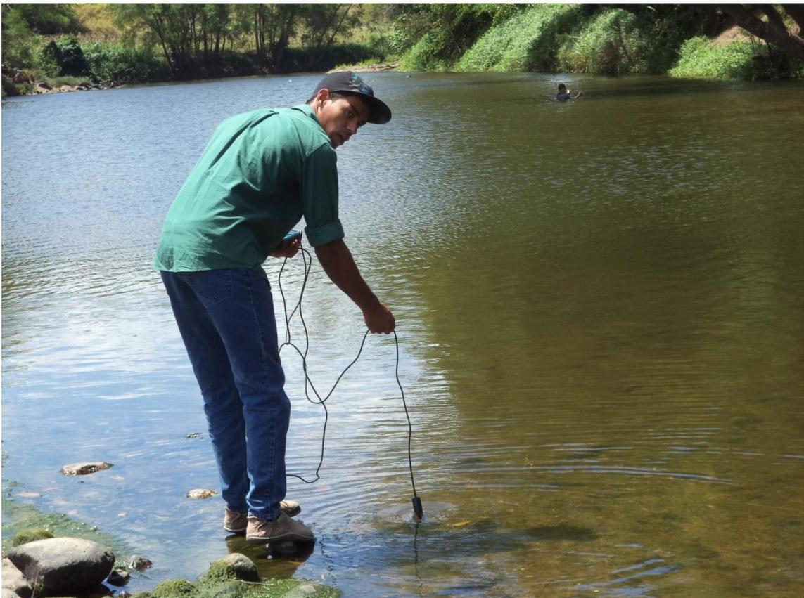
Figura 4.- Medición de parámetros físico-químicos del afluente del Río Choluteca para proyecto piscícola de I.H.A.D.F.A. (Marzo 2014)
